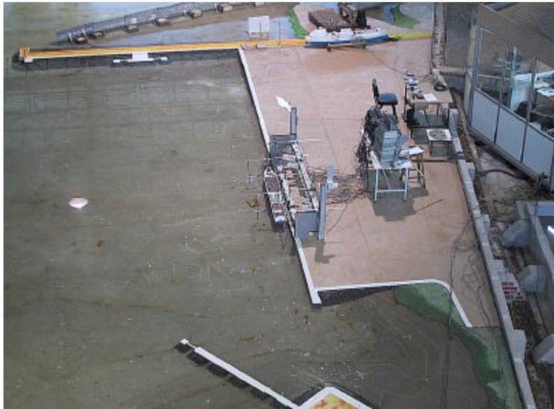
Figura 3. - Ensayo de comportamiento de barcos atracados.
