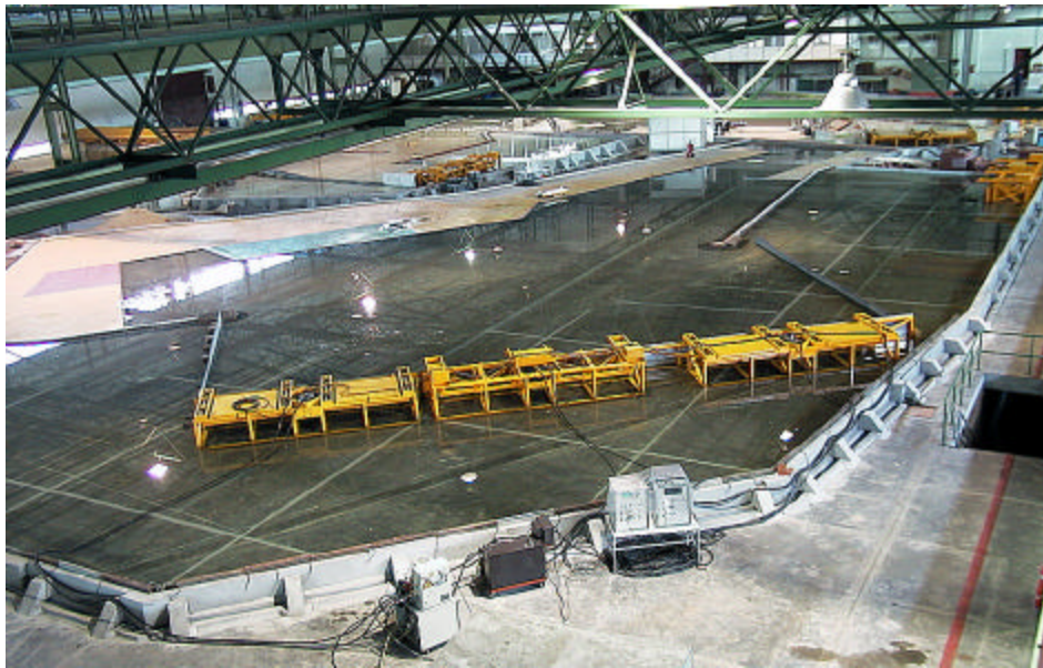
Figura 1.- Ensayo de agitación. Ampliación del puerto de Barcelona.
