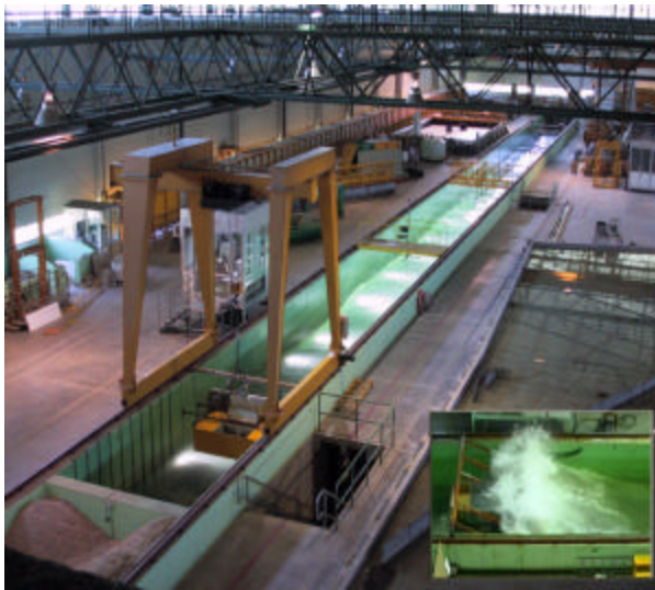
Figura 20. Canal de grandes dimensiones. Panorámica y detalle del ensayo.
