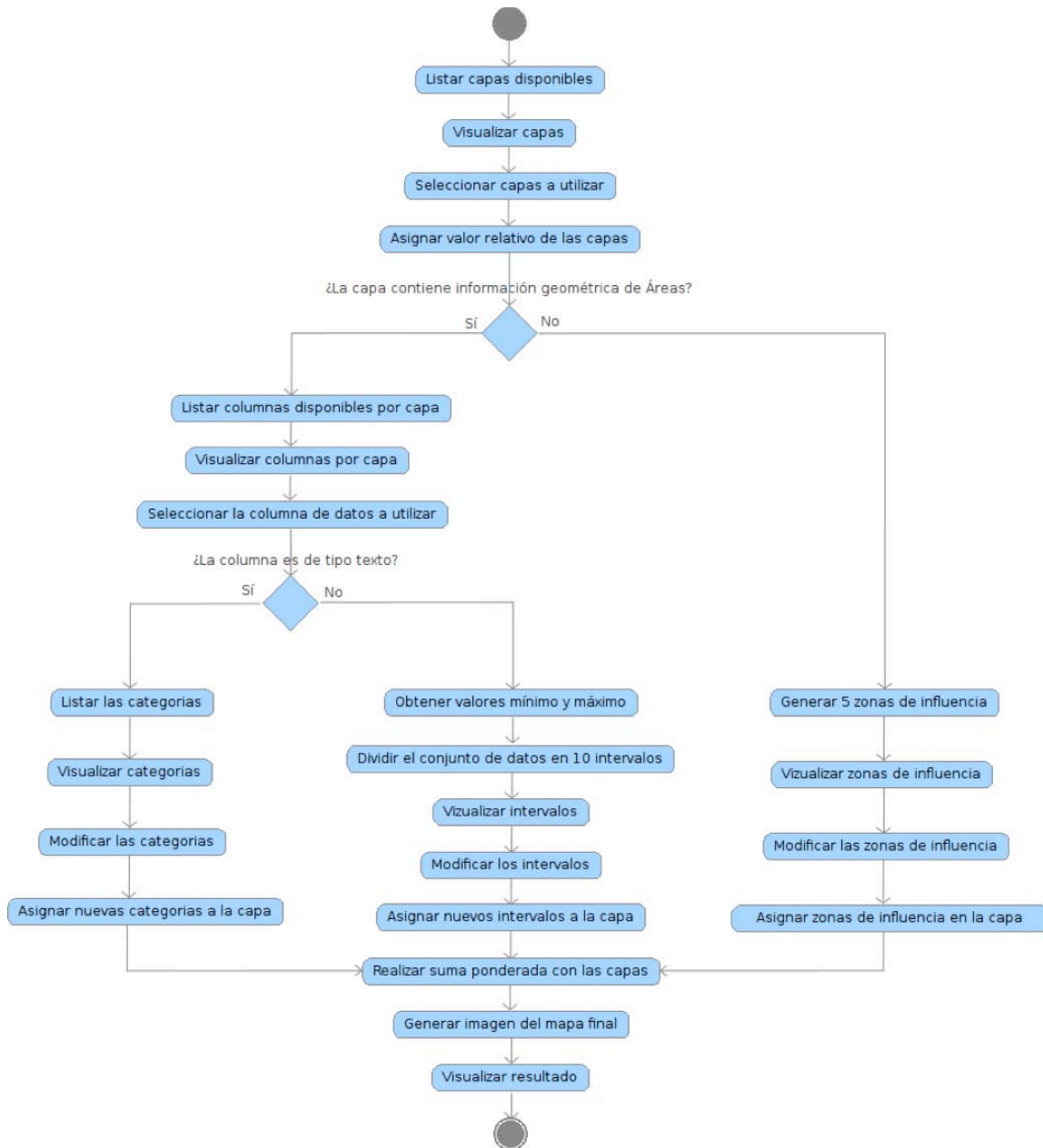
Figura #20. Diagrama que muestra la funcionalidad completa del sistema
