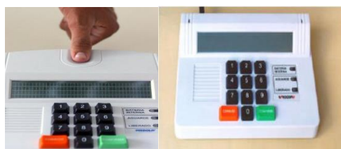
Esquerda (terminal do mesário com verificação biométrica) Direita (terminal do mesário sem verificação biométrica).
