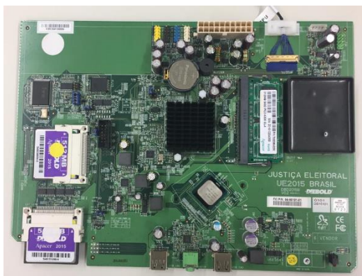
Imagem: placa-mãe da urna eletrônica (Fonte: TSE)
